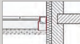
**Fugen-Füllstreifen als Raumfuge** im Anschluss an Kasten und Schlitzrinnen in gebundener und ungebundener Pflasterbauweise.
