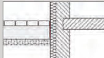
**Trenn- und Schutzlage** für Pflasterflächen in ungebundener Bauweise im Anschlussbereich an den Gebäudesockel, zum Schutz der Abdichtung und Dämmung (z. B. WDV-Sockel).
