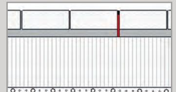
**Fugen-Füllstreifen für Dehnungs- bzw. Bewegungsfugen** für Pflasterflächen in gebundener Bauweise mit Pflasterfugenmörtel. Ideal geeignet für zusätzlichen Fugenverguss nach ZTV-Fug.
