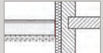
**Randfugen-Füllstreifen** für Pflasterflächen aus keramischen Plattenbelägen in gebundener Bauweise mit Pflasterfugenmörtel.
